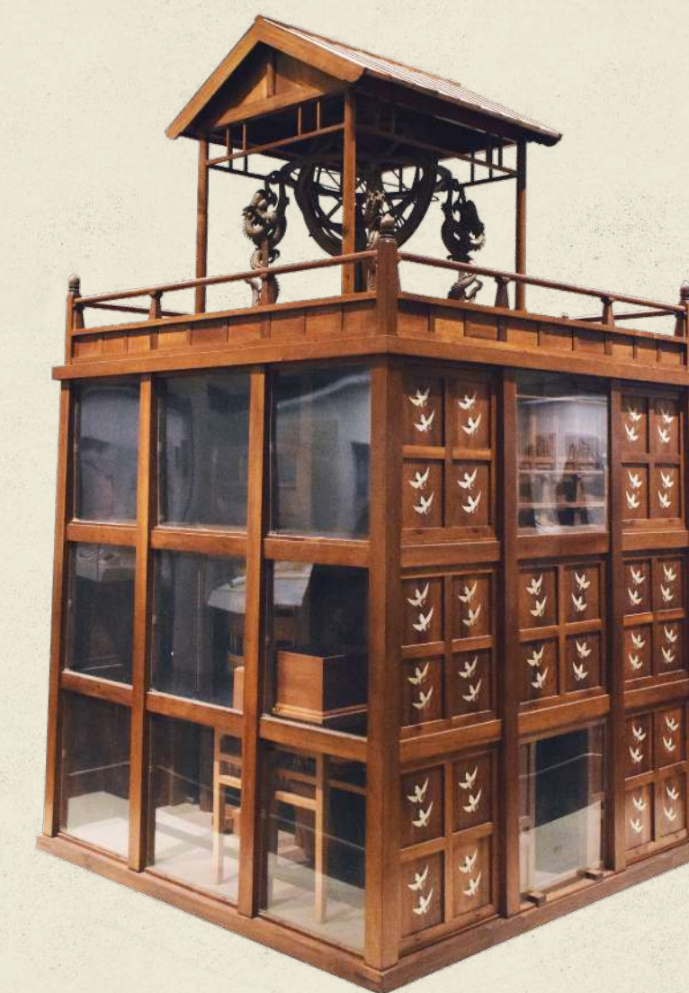
水運儀 集計時報時、天文觀測和 星象顯示功能
