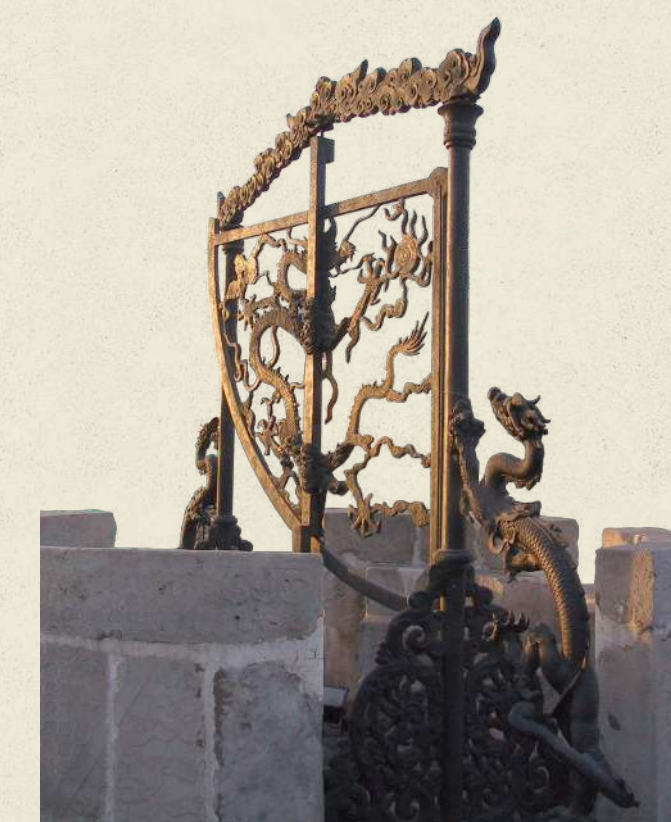
象限儀 測量恒星的地平高度和 天頂距離
