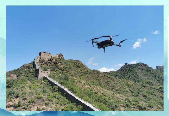
長城全線不乏懸崖峭壁,人力勘查有 一定難度。運用無人機,便能全面提 高勘查效率。將無人機拍攝所得的大 量數據,再結合人工測量收集到的資 料,建立數字模型。有了這些數字模 型,以及在長城安裝傳感器實時更新 數據,工作人員不用親身到長城現場 也能用電腦掌握長城資料,分析長城 損毁情況,也可模擬修繕方案的效果 評估修繕方案。
